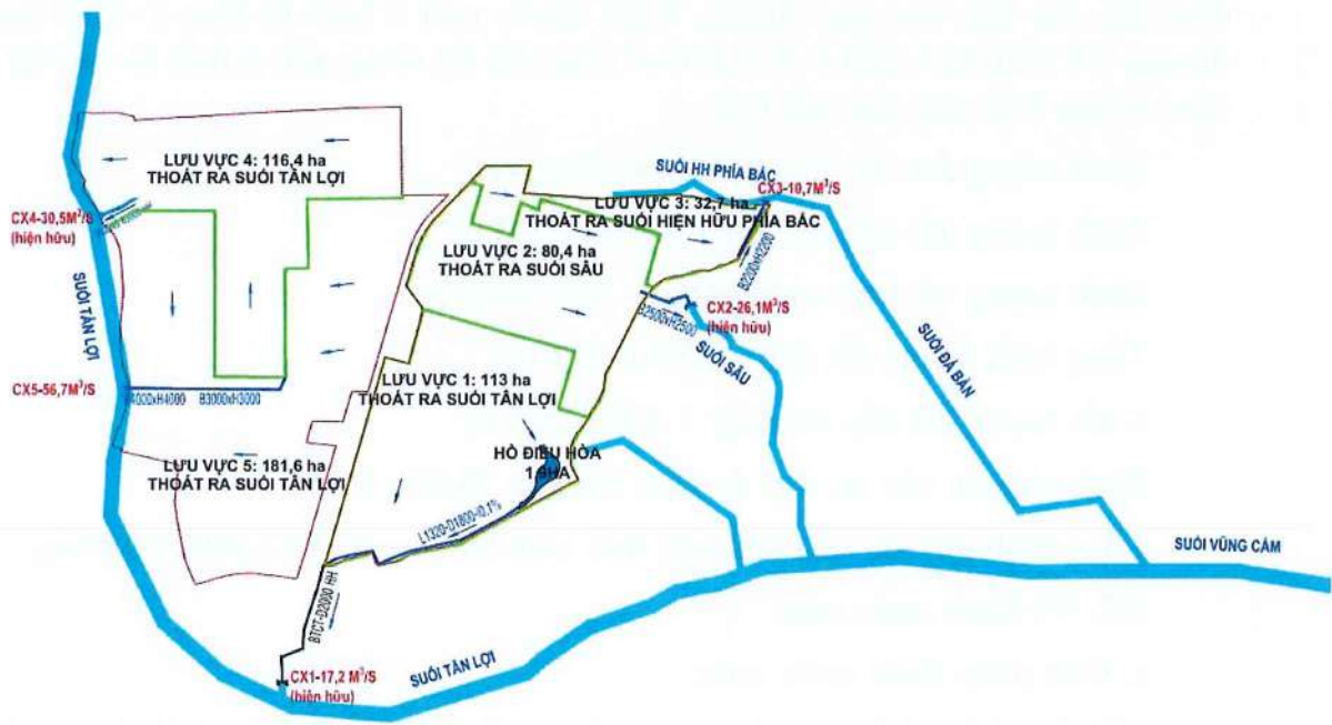
Hình 74. Sơ đồ phân chia lưu vực thoát nước mưa trong KCN Đất Cuốc
